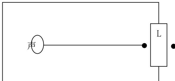
图 8-3 室内声源等效为室外声源示意图
