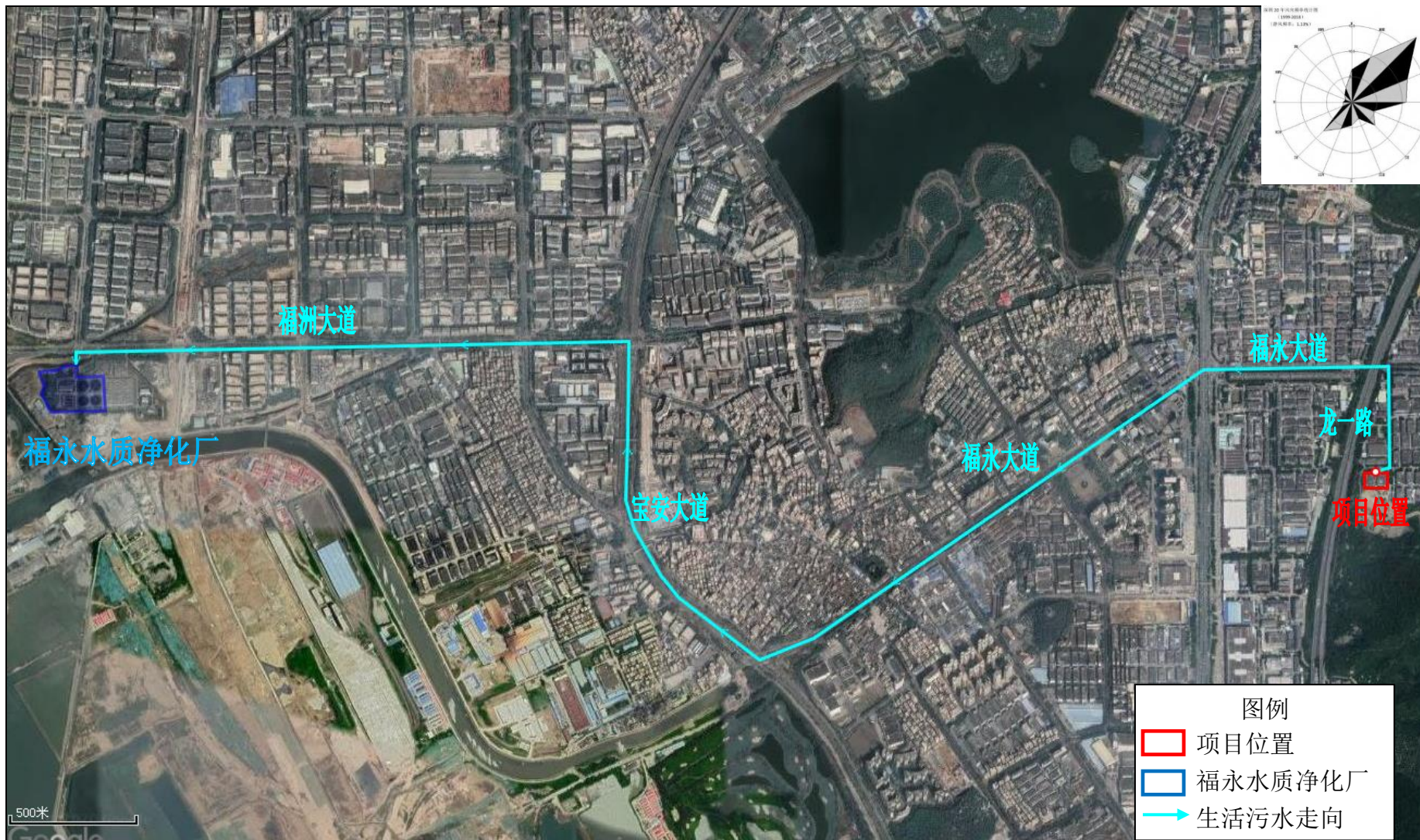
附图 15：项目生活污水管网走向图
