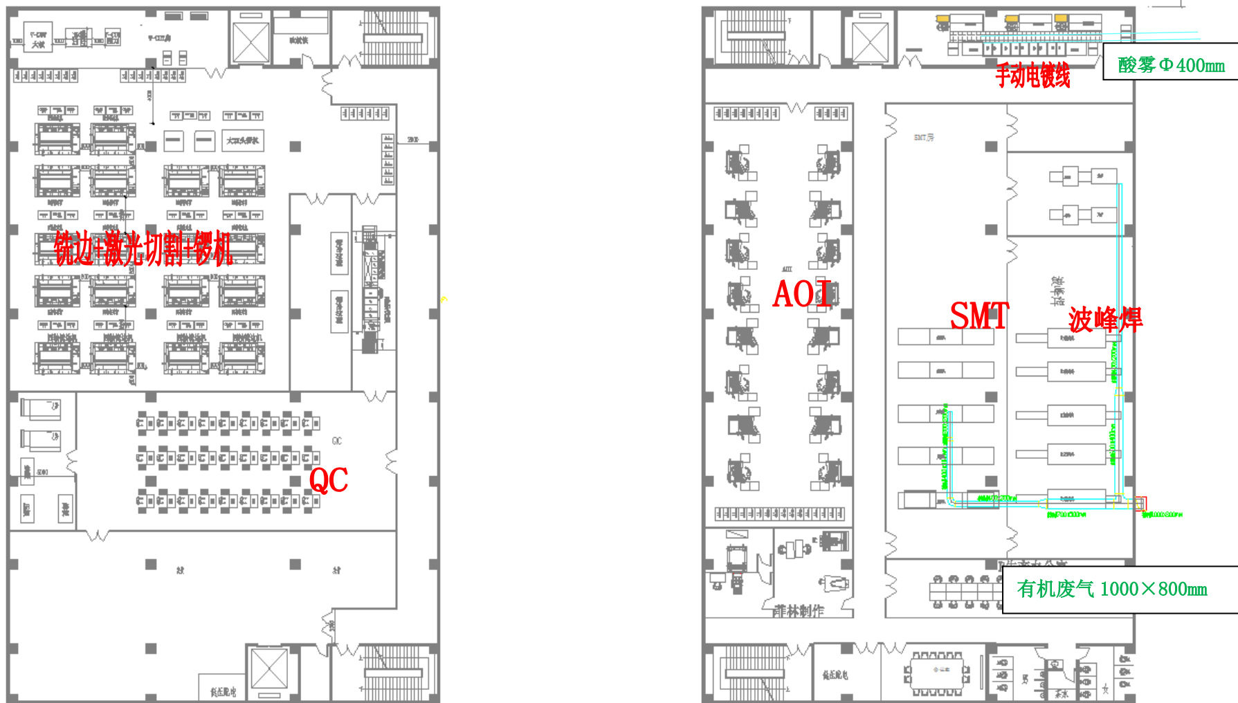
图 1.4-5 项目 4 楼废气处理设施管道布设图
