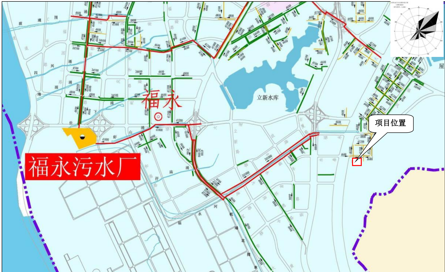
附图 13: 项目所在区域污水管网图
